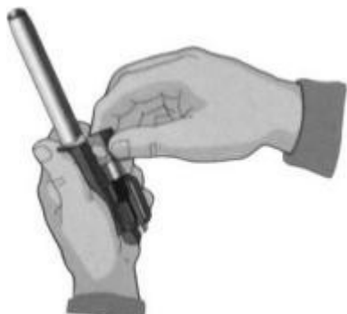
Рис. 7.17. Отделить затвор от затворной рамы
