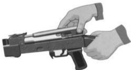
Рис. 7.16. Отделить затворную раму с затвором
