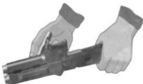
Рис. 7.18. Отделить газовую трубку со ствольной накладкой
