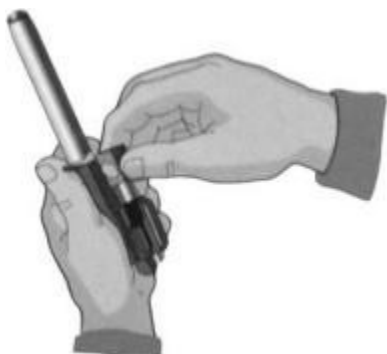
Рис. 7.17. Отделить затвор от затворной рамы
