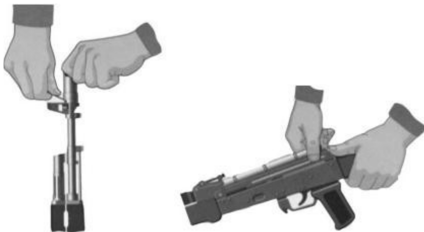
Рис. 7.13. Отделить Рис. 7.14. Отделить крышку шомпол ствольной коробки
