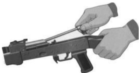
Рис. 7.15. Отделить возвратный механизм
