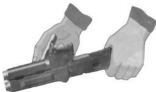
Рис. 7.18. Отделить газовую трубку со ствольной накладкой
