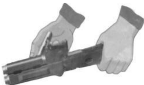
Рис. 7.18. Отделить газовую трубку со ствольной накладкой
