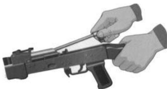
Рис. 7.15. Отделить возвратный механизм
