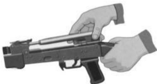
Рис. 7.16. Отделить затворную раму с затвором
