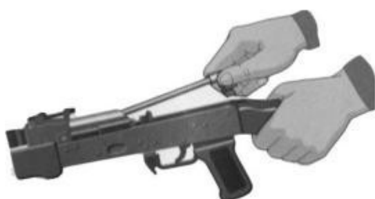
Рис. 7.15. Отделить возвратный механизм
